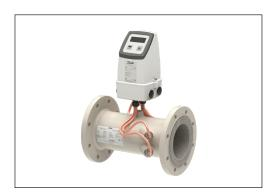
Der SONO 3500 CT ist ein Ultraschall-Durchflusssensor, speziell konzipiert für Heizund Kühlanwendungen sowie kombinierte Heiz-/Kühlanwendungen in Nah- und Fernwärmesystemen. In Kombination mit INFOCAL 9 dient er als Energiezähler für Wärme- und Kälteanwendungen. Der SONO 3500 CT ist nach MID-Klasse 2 zugelassen. Der zugelassene Durchflusssensor besteht aus einem Durchfluss-Sensorrohr, vier Messumformern mit Kabeln und einem Transmitter mit LCD-Display.
